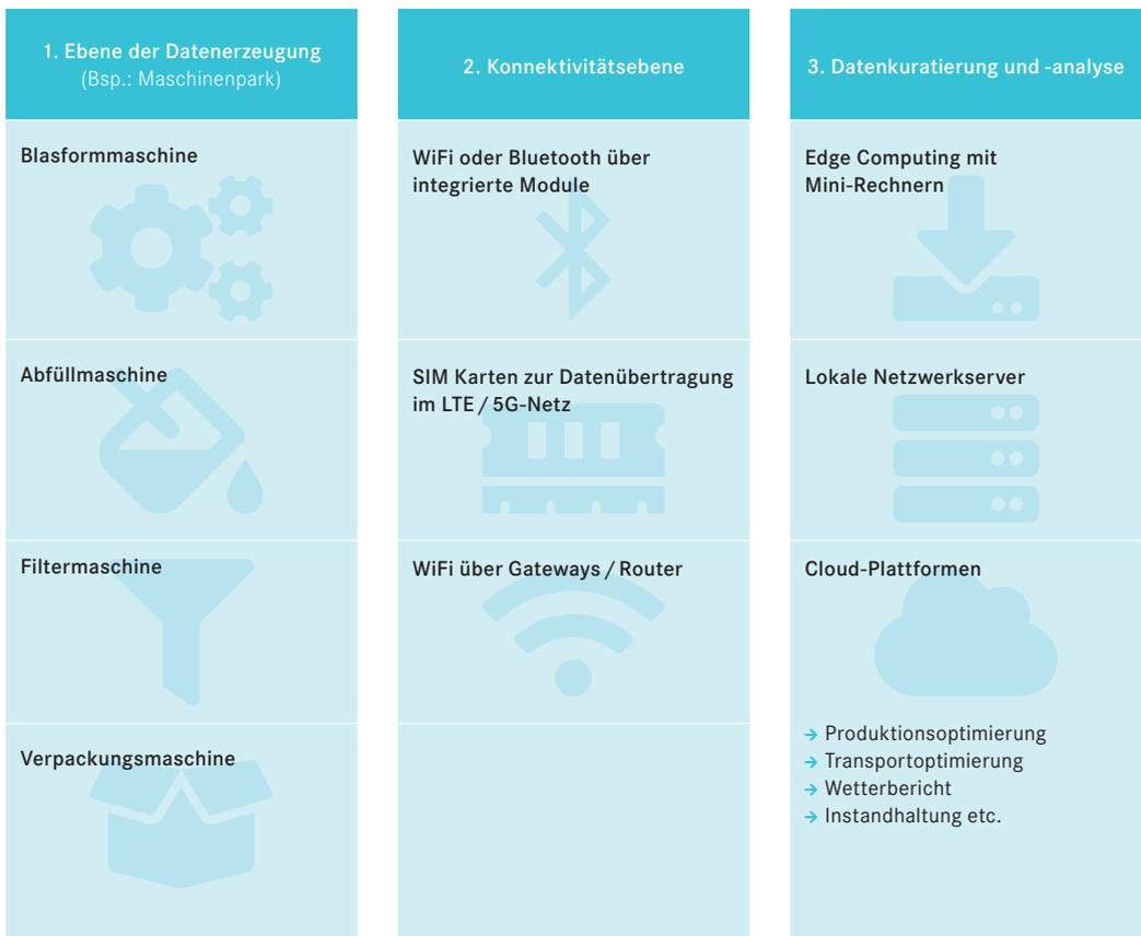
Abbildung 15: Ebenen der Datenverarbeitung am Beispiel eines Maschinenparks (1)
